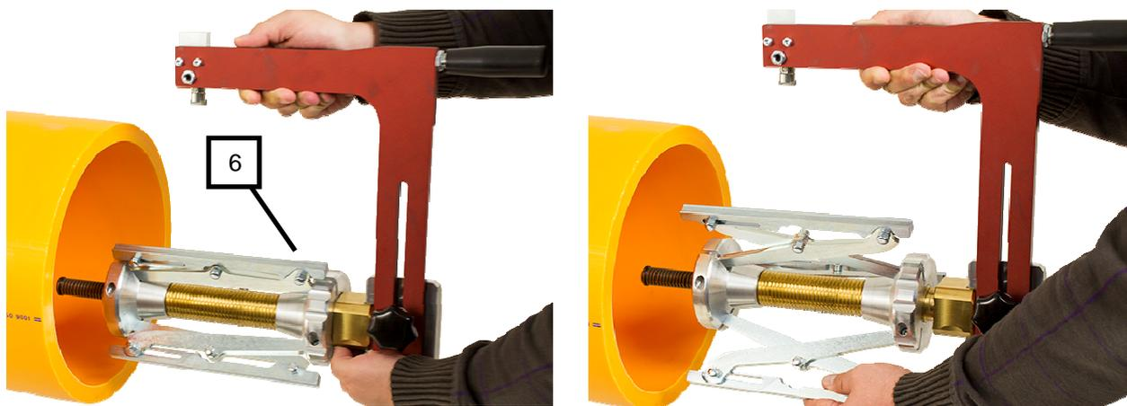
e) Ne pas insérer le racleur trop profondément dans le tube afin que le bras de pilotage (3) n'entre pas en butée avec son extrémité, avant la fin de la zone à racler.
