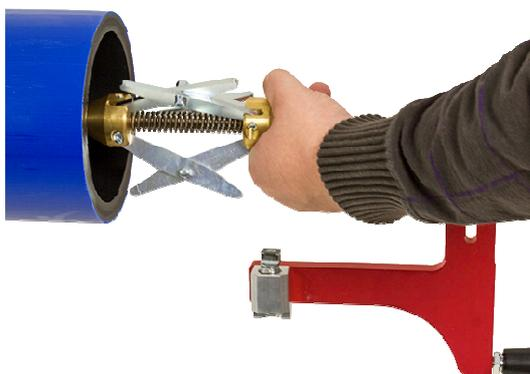
f) Les 8 embouts des ciseaux doivent entrer en contact avec la paroi interne du tube pour obtenir l'adhérence suffisante. Fixer l'outil dans le tube en tournant manuellement la mollette (9). Maintenir la tête de maintien pour qu'elle ne tourne pas.
